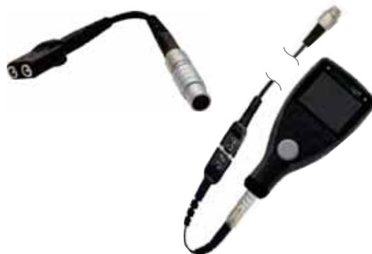
Stecken Sie zum Anschließen eines beliebigen 'nicht intelligenten' Zweielement-Messkopfs den Adapter einfach unten an der Messkopfaufnahme des Messgeräts an und folgen Sie den Anleitungen auf dem Bildschirm.
